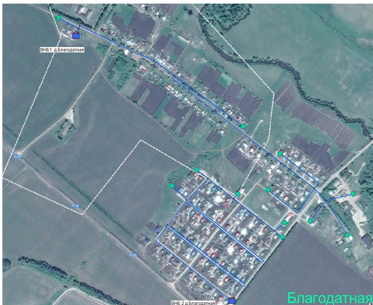
Рисунок 1-1. Зона централизованного водоснабжения д.Благодатная
